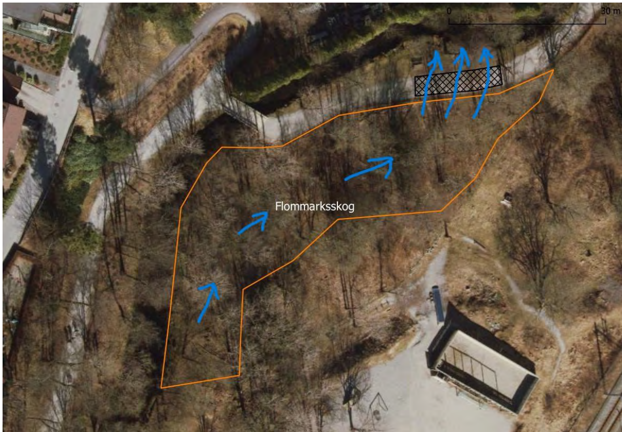
Figur 2. Flyfoto som grovt markerer flommarksskogen ved Friskolen, og problemområdet ved grusveien hvor det meste av vannet renner over og eroderer grus ut i elv og elvekant.
